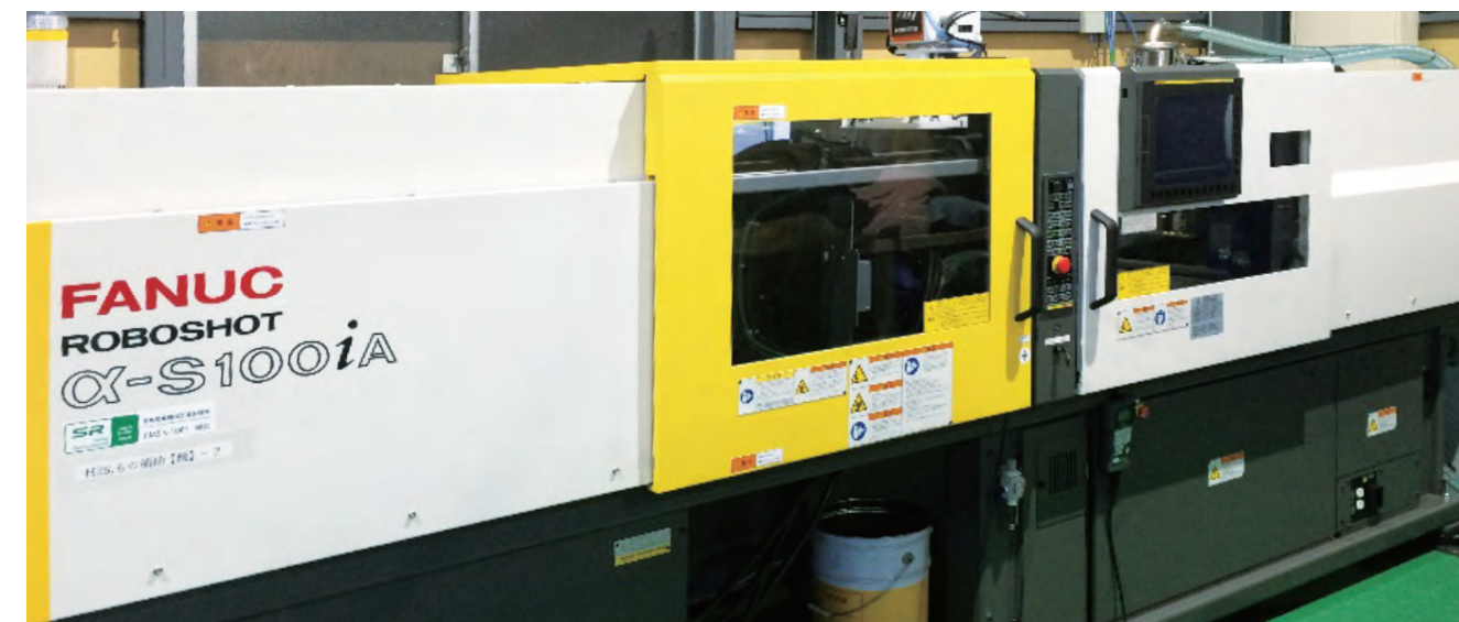
FANUCロボショット α-S100iA 125トン 1台
